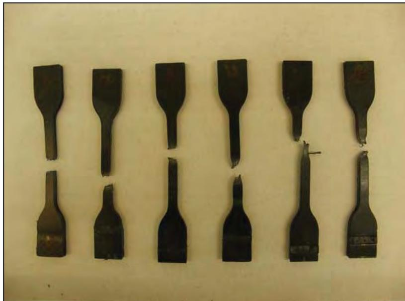
Detalle de probetas tras ensayo de tracción
