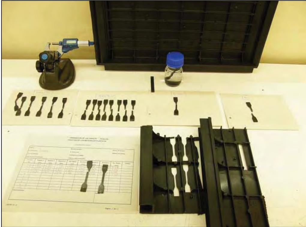
Vista general de arqueta de PP y probetas extraídas para la realización de ensayos
